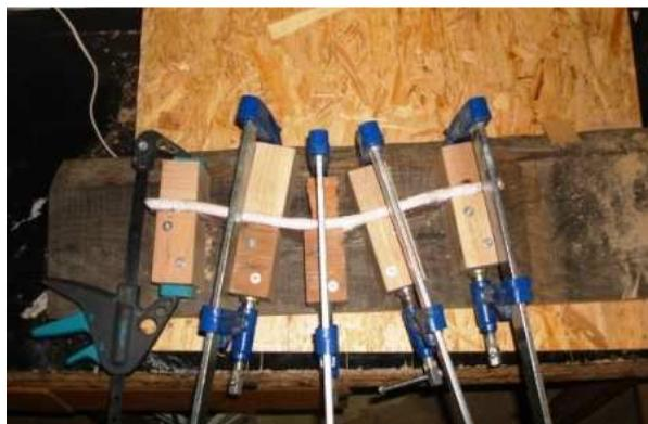
J'ai réalisé les dossier en lamellé collé de frêne avec un gabarit fait sur mesure (voir photo).
