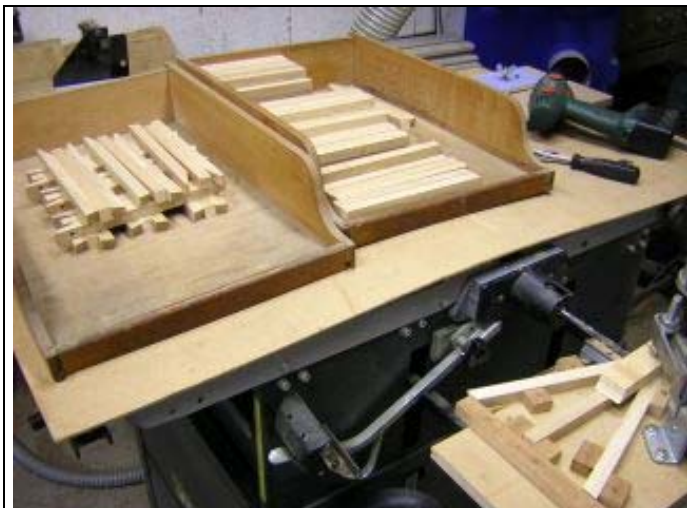
Gabarit de perçage à la mortaiseuse
