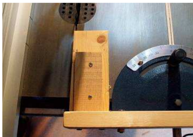
Réglage à environ 1,9^\circ du guide d'angle
