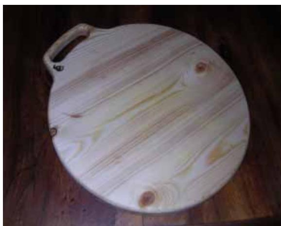
Exemple de réalisation entièrement réalisé au compas monté sur défonceuse (y compris la poignée).
