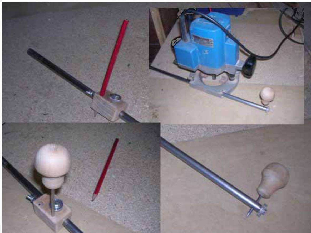
La tige en étiré de 12 mm sert aussi bien de compas pour la défonceuse que pour un crayon ou une point sèche
