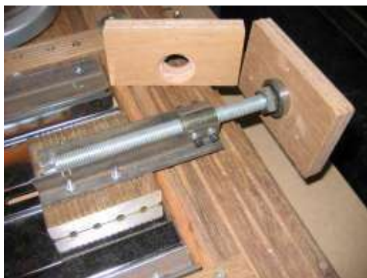
Le roulement à billes bloqué par le bois procure une commande pratiquement sans jeu.
