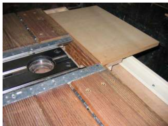
Le chariot en cours de montage (plaques supérieures de la table enlevées)
