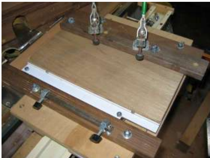
Le chariot transversal, auquel il manque encore le doigt de limitation de course. Le système de sauterelles est celui du chariot parallèle.
