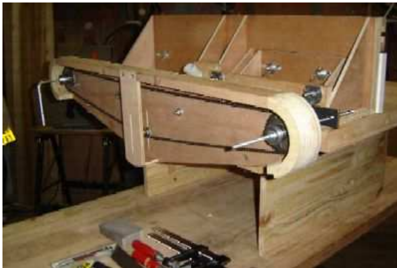
La chaîne du vélo de Jaja dans son boîtier ouvert. Cette photo a été prise avant que je décide d'augmenter le diamètre des tiges filetées.
