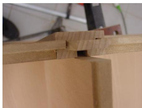
J'ai utilisé la même technique pour l'usinage des ces pièces, à savoir, la découpe des épaulements en premier lieu, pour tracer les mortaises. Finalisation des tenons en gardant les réglages de profondeur.
