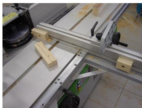
Les bois, ainsi préparés, sont placés sur les montants des piétements pour repérer la position et la taille des mortaises.
