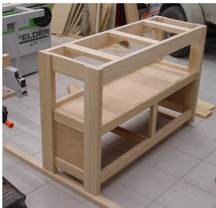
La base se compose de deux piétements symétriques reliés par une série de traverses ainsi que différents renforts rigidifiant l'ensemble. Le bas forme un bloc servant à recevoir trois tiroirs, surmonté d'un panneau cerné par un rebord servant de « pose-outils ». Les tiroirs sont légèrement renfoncés par rapport à la structure afin de limiter les poussières et les copeaux qui pourraient y tomber.
