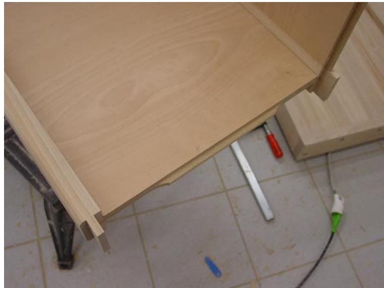
Un petit assemblage à blanc pour vérifier que toutes les rainures sont bien alignées, surtout les rainures des traverses des piétements avec les rainures des traverses frontale et arrière.
