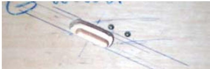
Déterminer ensuite la longueur de l'entaille dans laquelle coulissera la bague à copier. La largeur des lattes des persiennes étant de 35 mm, l'entaille fera :  $35 + (\text{Øguide} - \text{Øfraise})$ . Soit  $35 + (17 - 8) = 44$  mm. Portez donc 22 mm de part et d'autre du centre dans l'axe de la mortaise.
