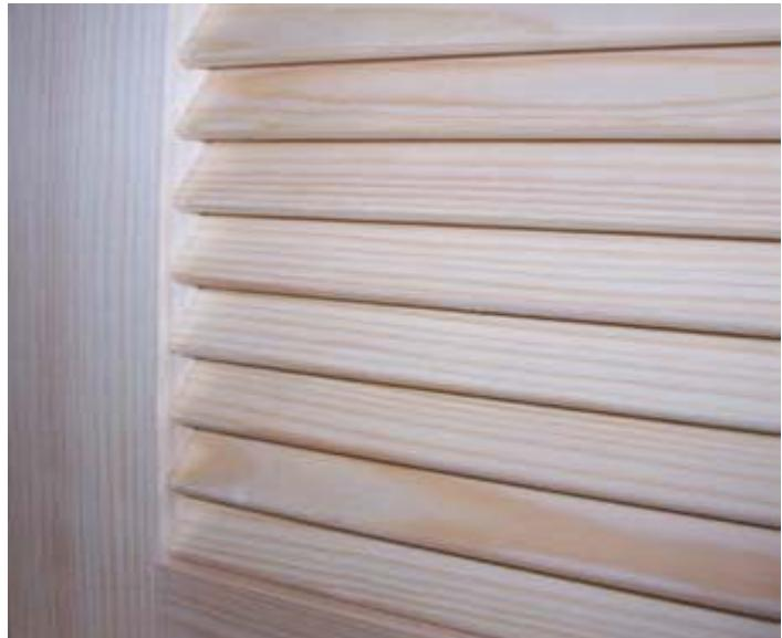
La défoneuse doit être équipée d'une fraise à rainurer de Ø8 et d'un bague de copiage. Celle que j'ai utilisée, faisait Ø17.
