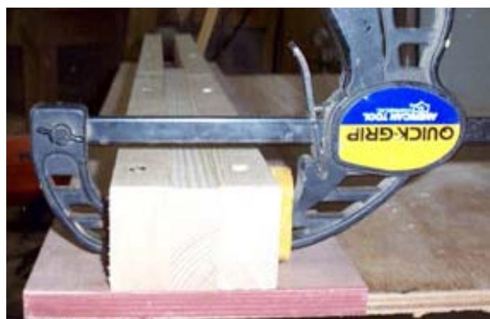
Fixer les pièces (3) sur le CP (2) en enserrant un bois de 28mm à l'aide d'un serre-joint.
