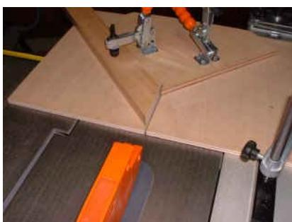
Le positionnement de la baguette de rainure a été fait en place. Il faut usiner les coupes par paires : la planche A est sciée en étant fixée sous la sauterelle gauche ; la planche B qui lui sera associée en angle au montage sera sciée fixée sous la sauterelle droite.
