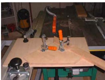
Deux chutes de contre-plaquée achetées en GSB : celle du dessous est en 10, celle du dessus en 18. Elles sont collées/vissées l'une sur l'autre. Sous celle du dessous (à droite sur la photo), une petite baguette ajustée à la dimension de la rainure de mon chariot de scie, est aussi vissée/collée .
