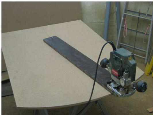
J'ai ensuite réalisé la mise en forme des pièces courbes. Pour les côtés, j'ai utilisé une défonceuse montée sur un « compas ».
