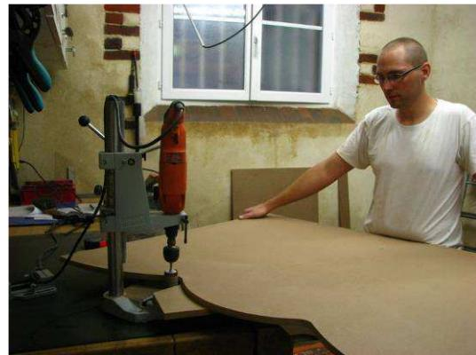
Pour la lisse haute, j'ai imprimé la forme désirée sur un traceur de plan à l'échelle 1. Je l'ai ensuite collé à la colle en bombe repositionnable, avant de la découper à la scie sauteuse. Les bords n'étant pas réguliers, je les ai égalisés avec un cylindre à poncer.
