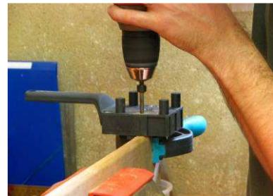
L'étape suivante consiste à défoncer les réservations des fers de fixation et à assembler par tourillons le cadre de façade qui recevra le plexiglas. Les tourillons ont 6 mm de diamètre et les trous légèrement supérieurs pour faciliter le démontage et éviter de fendre le médium.
