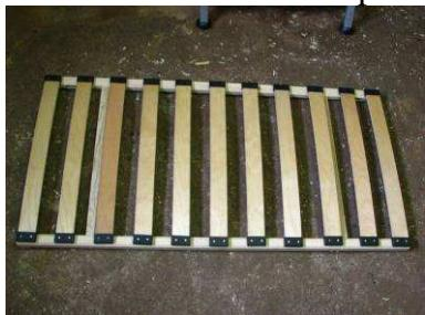
J'ai fabriqué un cadre à l'aide de tasseaux de 38\*40. Les pièces de plastique servant à fixer les lattes sont modifiées. Les ergots sont coupés et la pièce percée de deux trous pour laisser passer la tête des vis.
