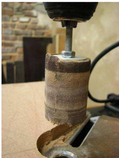
Pour réaliser le cylindre à poncer, j'ai assemblé 3 disques de MDF entre eux avec une tige filetée. J'ai ensuite recouvert ce cylindre de papier de verre (grain 80) collé avec de la colle néoprène.
