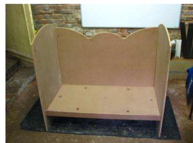
Un tasseau est mis en périphérie du lit afin de soutenir le panneau de fond, percé lui de trous de diamètre 30 mm pour l'aération du matelas. Pour renforcer la partie centrale et éviter que le bois ne s'écarte, un autre tasseau est emboîté à « mi-bois » et retenu par une queue d'aronde.
