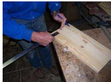
Traçage des emplacements pour la pose des lamelles sur tiroir.
