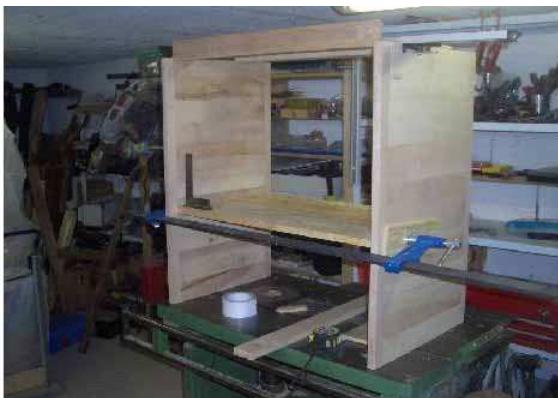
Vue arrière. (A l'avant, il y a une barre transversale au plus haut, et pas de barre en bas).
