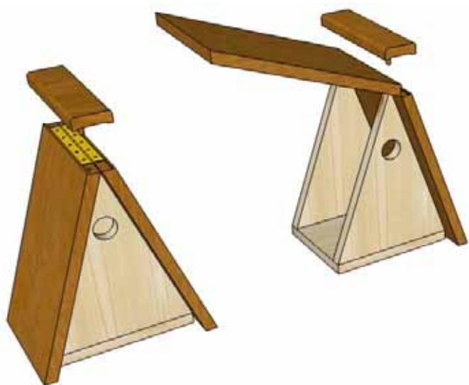
Dans ce second modèle c'est un pan du toit, pivotant grâce à une charnière piano, qui permet l'accès à l'intérieur du nichoir.
