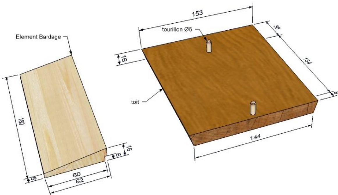
Des planches en sapin non traité conviendront très bien. J'ai tout fait avec des épaisseurs en 16 mm. Le toit est amovible et se positionne grâce à deux tourillons Ø6. Ceux-ci seront collés sur le toit uniquement. Le biseau peut être réalisé facilement à la scie circulaire en inclinant la lame. Mais c'est aussi réalisable avec une bonne râpe ou un rabot. Les assemblages sont faits par clouage.
