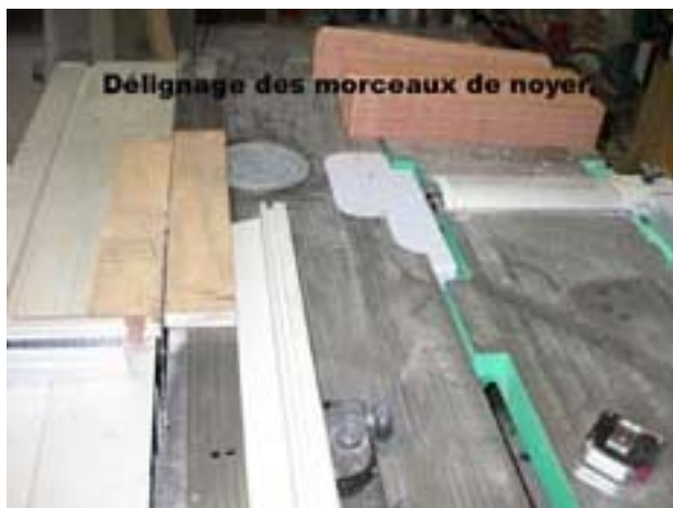
Délignage des morceaux de noyer
