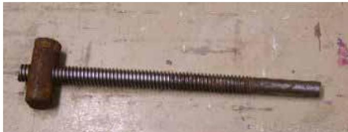
Un morceau de tige filetée de 150 mm de long percée et taraudée à un diamètre de 5 mm en bout permettra d'y fixer la rondelle.
