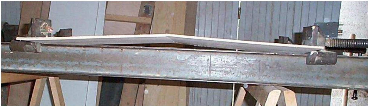
Utilisation d'un tasseau et de serre-joints pour éviter le flambage
