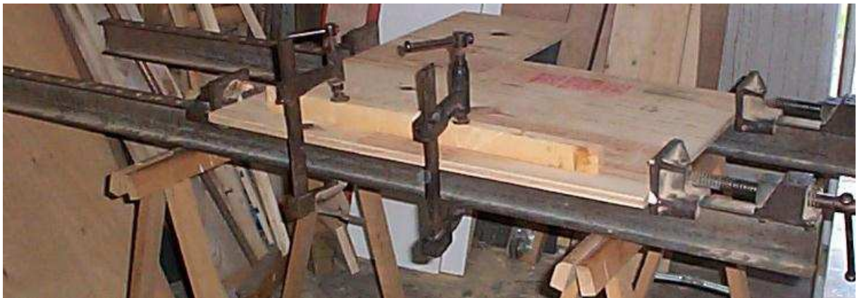
Utilisation d'un tasseau et de serre-joints pour éviter le flambage
