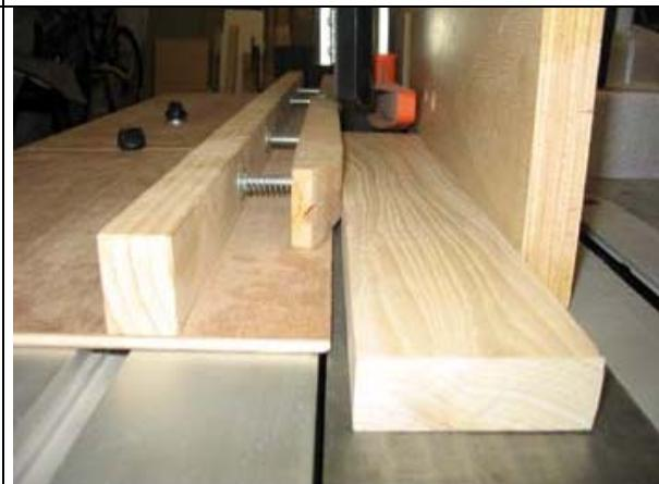
Ci-dessous un photo reportage montrant le mouvement des presseurs, au fur et mesure que la pièce avance devant l'outil.
