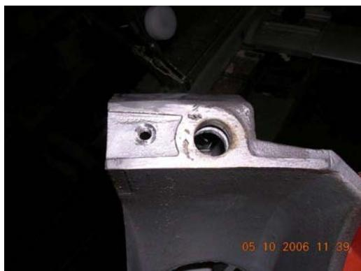
Perçage trou de 16mm et dessous trou de 6mm taraudé pour vis butée de retour zéro.
