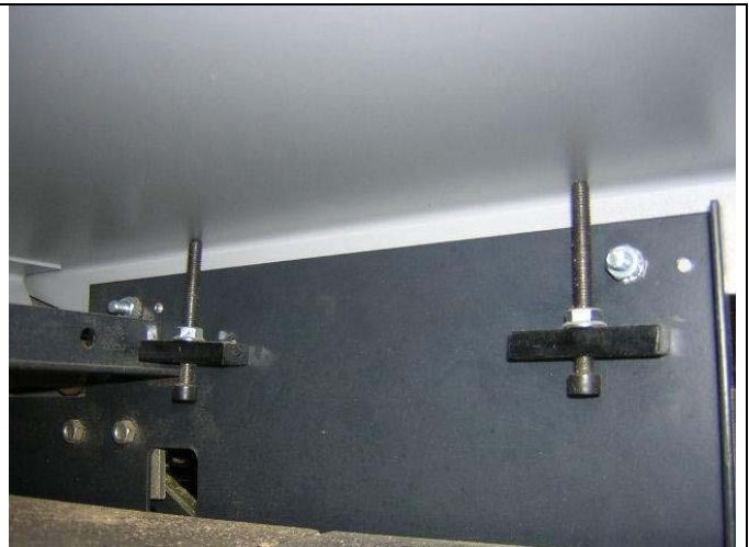
Fig.7 - Butées table sortie à Gauche
