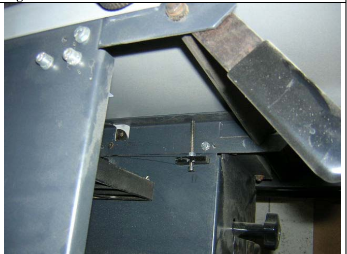
Fig.9 - Butées table entrée à Droite
