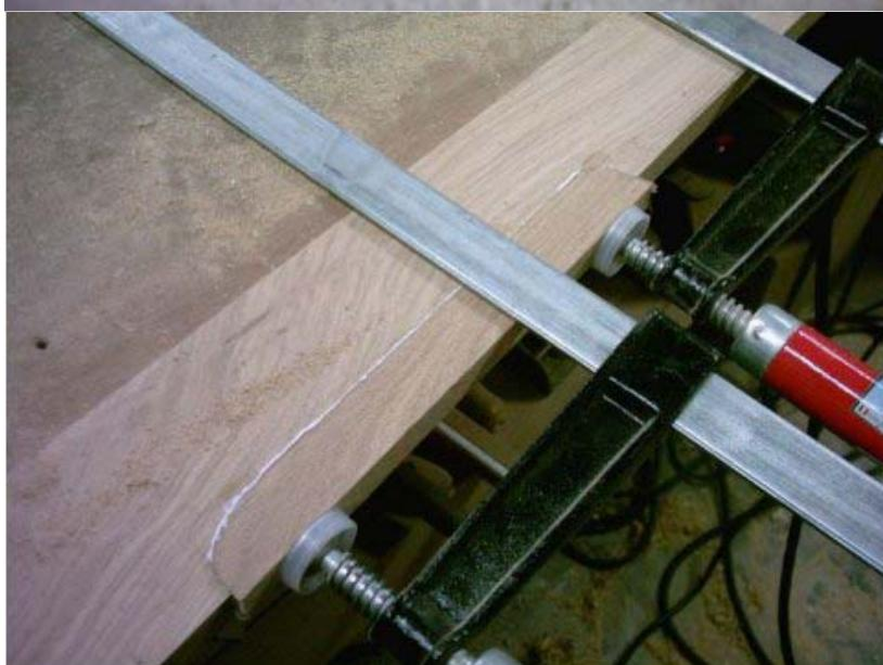
La pièce est collée, puis rabotée et poncée. On ne doit plus rien voir si l'on prend soin de découper la pièce complémentaire dans une chute de la même planche.
