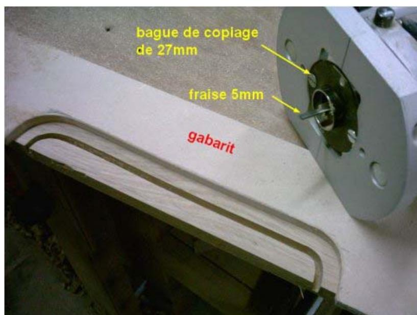
Pour faire la découpe, on emploiera la grande bague de copiage. La bague de copiage glisse sur un gabarit et une rainure de quelques mm de profondeur suffit pour définir la découpe à réaliser.
