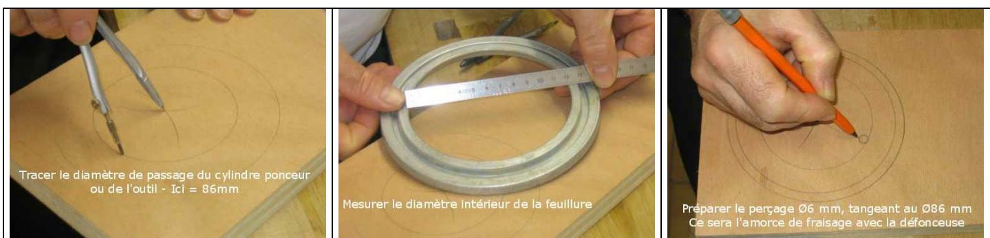
Après avoir débité le rond à la scie à ruban, j'ai utilisé ma défonceuse montée sous table avec une fraise  $\varnothing 6$ . Perçage du centre de la pièce avec un foret  $\varnothing 5$ . Ce sera le centre de rotation de notre pièce. Un autre perçage  $\varnothing 6$ , tangent au cercle  $\varnothing 86$  permettra de démarrer la défonceuse avec la fraise déjà engagée sur une profondeur de 2 ou 3 mm.
