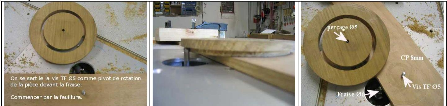
Le réglage de la distance à la fraise est facilité par la présence du trou tangent Ø6, percé initialement. Il suffit donc de monter la fraise de 2 à 3 mm à l'intérieur. Brider à nouveau les serre-joints et de procéder à une première passe légère. Continuez en plusieurs étapes, jusqu'à ce qu'il ne reste que 2 ou 3 mm de bois. Retourner la pièce et clouer une petite plaque de CP. Cela permet de rendre solidaires les 2 pièces pour terminer le fraisage de séparation.
