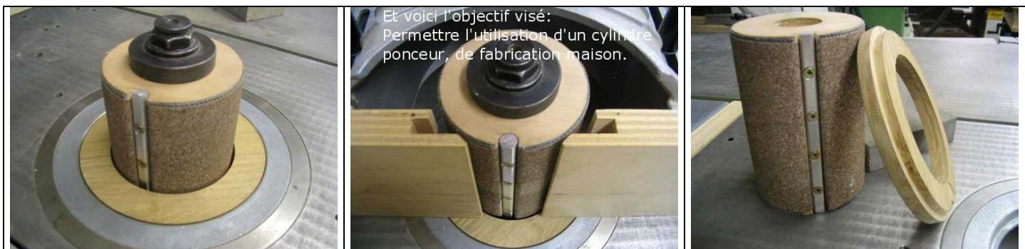
Mon cylindre ponceur ( $\varnothing 83$ ) fabriqué, je me suis trouvé avec une ouverture du puits de toupie trop importante. Le rond de poêle immédiatement inférieur ( $\varnothing 75$ ) ne permettait pas le passage du cylindre. Pour des questions de sécurité, je me suis décidé à réaliser un disque en bois à la dimension qui m'était nécessaire. Le reportage ci-après vous montre comment je m'y suis pris.
