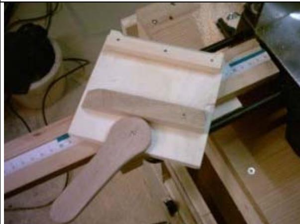
Une butée mobile à blocage rapide peut se fixer à gauche ou à droite de la machine, ce qui permet de couper rapidement et avec précision, des séries de bois de même longueur.
