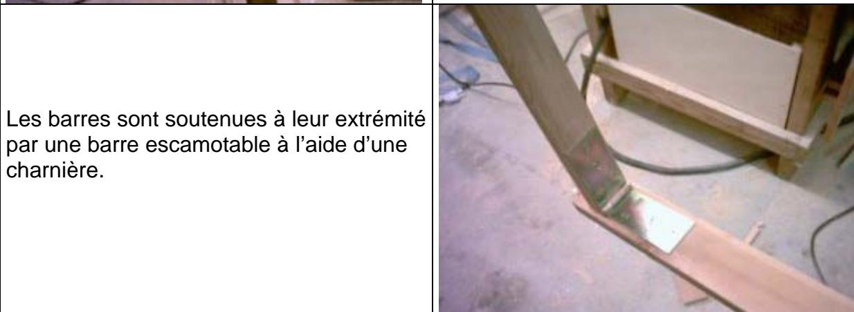
Les barres sont soutenues à leur extrémité par une barre escamotable à l'aide d'une charnière.
