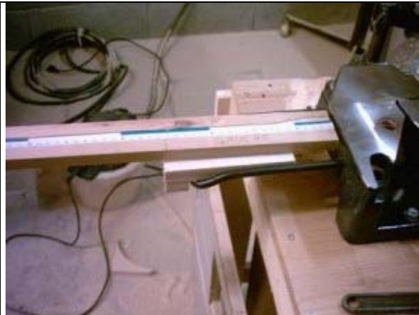
Sur le dessus des barres j'ai inséré, dans une rainure, des mètres plastique que les grandes surfaces mettent à la disposition des clients, les mesures partant de chaque côté de la lame.
