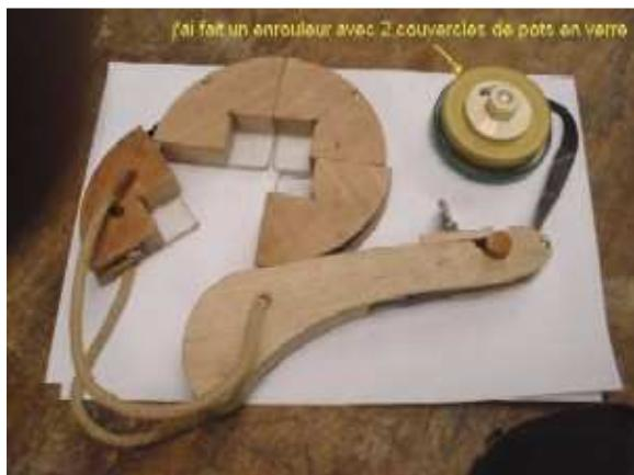
L'enrouleur a été réalisé avec deux couvercles de pots de verre, mais il est aussi possible de le réaliser au tour.
