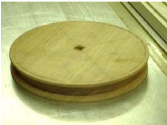
Turner une « roue » de 10 cm de diamètre, avec une gorge de 10,5 mm de large et 10 mm de profondeur.
