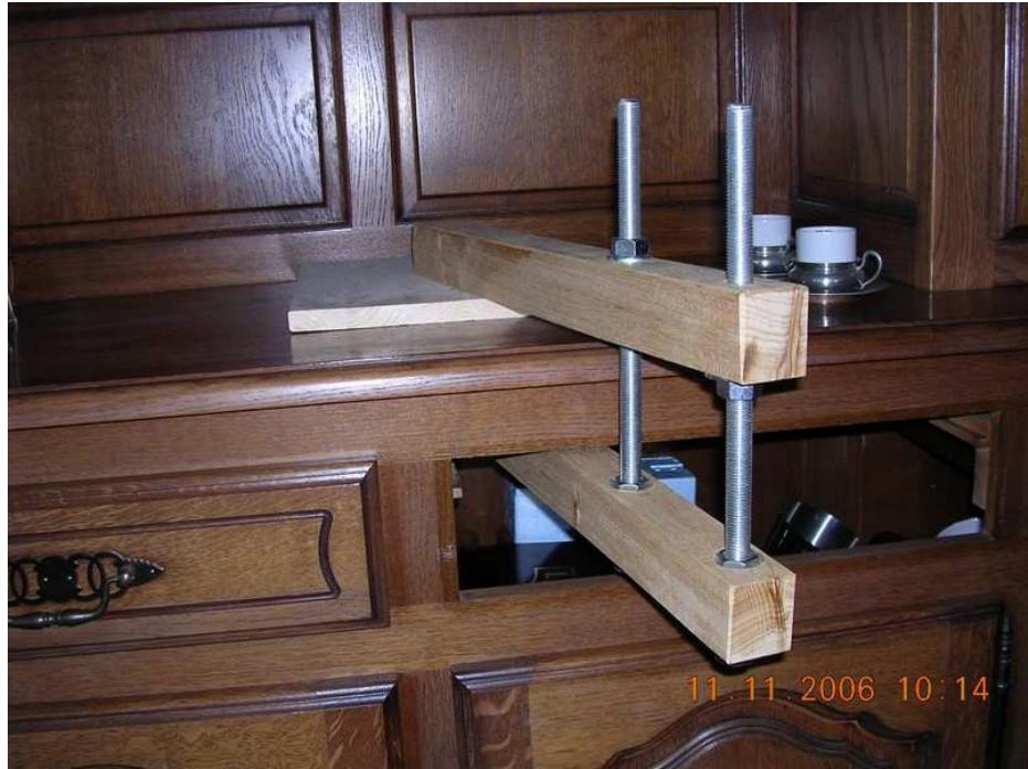
Voilà en deux temps trois mouvements la mise sous presse de la cloque après injection de colle et protection avec un morceau de film étirable transparent pour éviter le collage du martyr.
