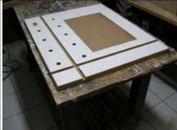
A l'emplacement du rectangle de tôle qui recevait la scie j'ai ajusté une coupe de MDF de 22 mm en faisant une feuillure périphérique de cette épaisseur et 12 mm de large; la table faisant 26 mm d'épaisseur, il restait 4 mm qui ont servi à recevoir la coupe de medium.
