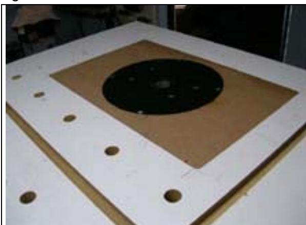
La défonceuse Lamello ne comporte que deux trous dans son embase. J'ai déposé cette dernière et j'y ai fait quatre perçages de 5.2. Je ne les ai pas taraudés. J'ai utilisé des vis méca de 5 à tête fraisée et des écrous auto bloquants.
