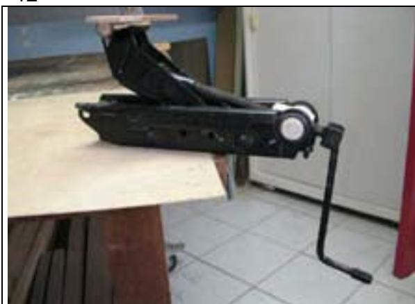
J'ai fait sauter la platine inférieure et scié les ailes du cylindre. Un manche de lime a été sacrifié et emboîté à force.
