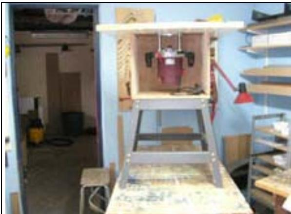
Il y a une grande course dans la plongée de la défonceuse et je me suis fait surprendre car il ne me restait que 6 cm entre le bas du caisson et la grille de ventilation de la défonceuse.
