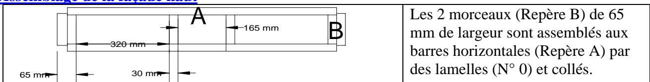
Les 2 morceaux (Repère B) de 65 mm de largeur sont assemblés aux barres horizontales (Repère A) par des lamelles (N° 0) et collés.
