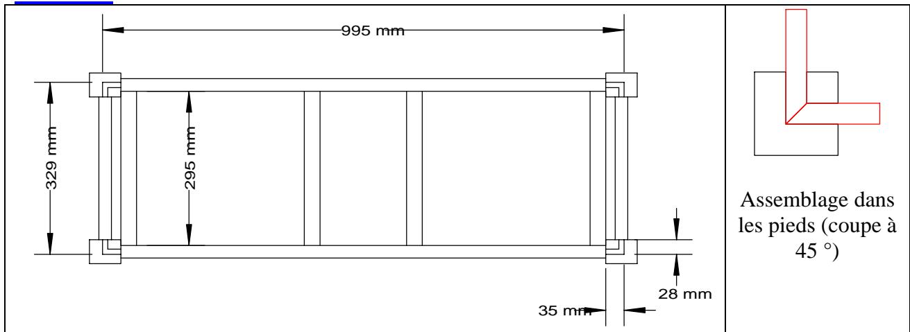
Chaque traverse sur laquelle on va fixer les coulisses, est assemblée par 4 vis biaises (bien maintenir avec cales et serre joint pour éviter tout déplacement lors du vissage).
