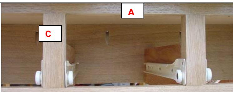
Les 2 morceaux (Repère C) de 30 mm de largeur sont assemblés aux barres horizontales (Repère A) par tourillons et collés.
