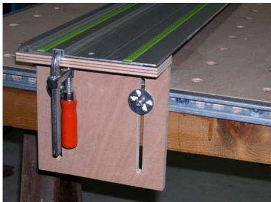
Il ne reste plus qu'à poser le rail sur les assemblages en équerre
