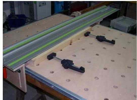
Il n'y a plus qu'à commencer l'usinage ; en jouant sur les assemblages en équerre on peut s'adapter à l'épaisseur de la pièce à travailler, veillez à bien stabiliser l'ensemble au moyen des papillons, éventuellement sur les pièces à usiner étroites vérifier le niveau perpendiculairement au rail pour que le résultat soit correct.
