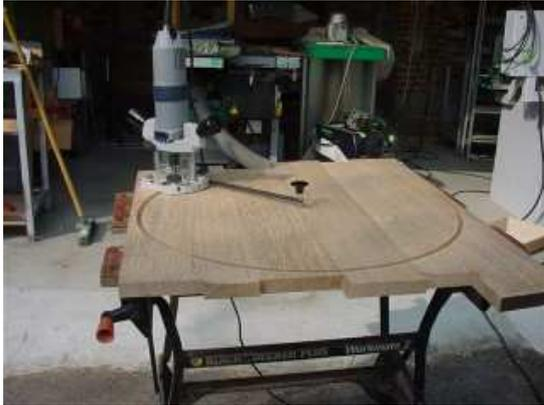
La découpe a été réalisée à la défonceuse. Cette défonceuse a été livrée avec le dispositif permettant de découper des cercles. L'inconvénient de ce système est que la pointe laisse une trace à la place du centre, il faut donc penser à travailler sur la face qui sera mise en dessous. Pour pallier cet inconvénient, on peut se fabriquer le centre à coller proposé sur ce site par Santé (rubrique *Trucs et Astuces*)
