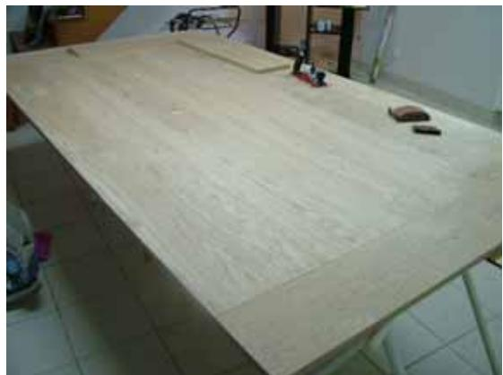
Faire tous les trous des sept planches de 2 m et aussi ceux des deux planches latérales de 126 cm. Ensuite placer les chevilles à la main et au marteau sur une tranche, encoller avec de la colle à bois super résistante à prise pas trop rapide et positionner la deuxième tranche afin d'enfoncer les chevilles. Finir l'association au marteau avec une protection en bois.
