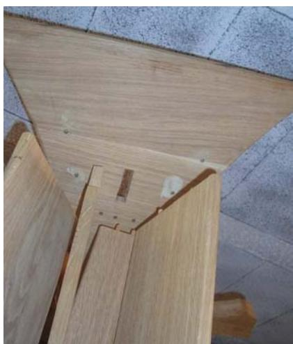
Avant d'effectuer le collage, un montage à blanc est indispensable. Cela permet de faire les derniers ajustements et de préparer les serre-joints et cales nécessaires pour le serrage.
