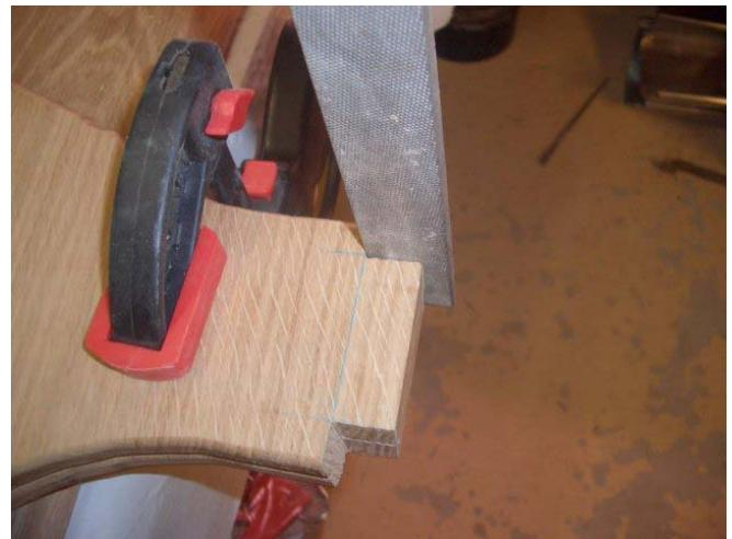
Il reste à réaliser les tenons inférieurs des jambes. Là aussi j'ai utilisé la scie à ruban et pratiqué en une seule opération en fixant les deux jambes ensemble. J'ai fignolé à la râpe.
