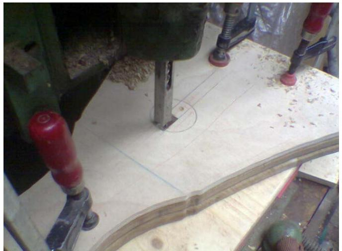
Le chantournage a été réalisé à la scie à ruban et terminé sur la toupie au cylindre ponceur. A l'époque je ne disposais pas d'un calibreur. La mortaise a été pratiquée avec ma mortaiseuse à bédane<sup>2</sup>. J'ai dû faire attention de ne pas toucher aux tourillons ! Mais je les avais placés suffisamment bas.
