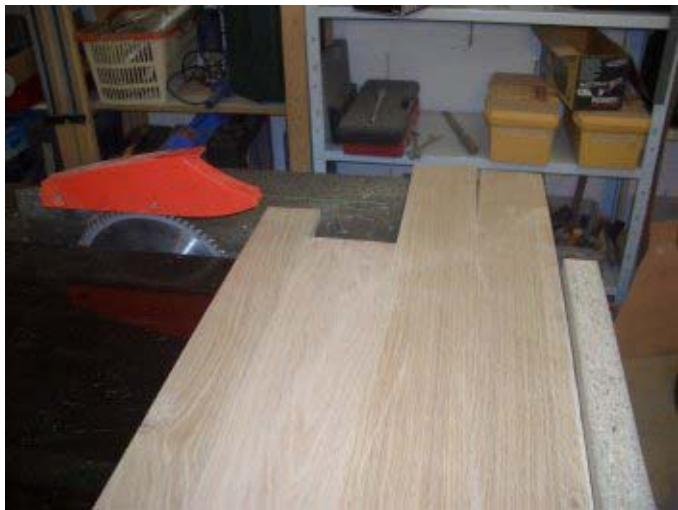
Une fois le plateau mis à dimensions, nous allons passer à la réalisation des jambes du pétrin. Confectionner pour cela un gabarit en CP de 10 mm. Après traçage, débit à la scie à ruban.
