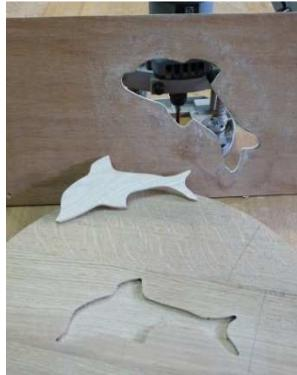
Tout a été réalisé à la défonceuse en utilisant la même fraise mais des douilles de diamètre différent.
