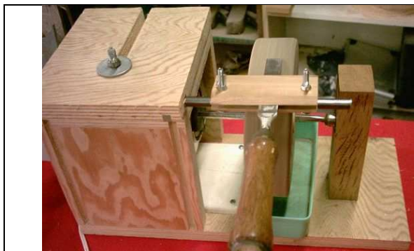
Affûtage à contre-sens (support fixé sur le dessus)
