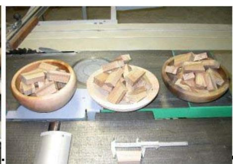
Délignage de vos planches aux largeurs prévues. Dégauchissage, rabotage et coupe des segments au bon angle.
