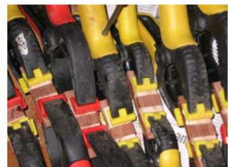
La coupe des éléments constituant l'anneau décoratif étant souvent très petits, fabriquer une fausse table de scie pour que les petits morceaux ne tombent pas dans la rainure d'aspiration entre la lame de scie et la table (voir photo ci-dessus à gauche) Là encore ,procéder étage par étage pour chaque morceau. Rendre plane à la ponceuse d'établi toutes les surfaces devant être collées. Une fois chaque élément constitué, le couper à 11°25, assembler et coller comme n'importe quel étage.
