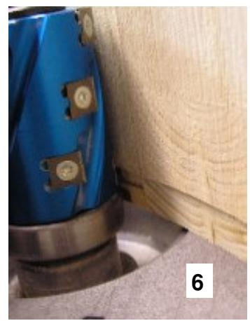
Faire un deuxième trait de scie près du deuxième bord (photo 5). Les ébauches des 2 parties du moule sont maintenant prêtes pour être passées au calibreur équipé d'un roulement à bille.
