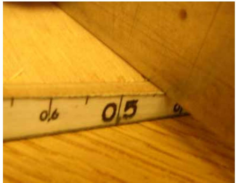
Il se trouve que la mesure de l'épaisseur d'un contre-plaqu  de 5mm me donne 4,4mm au pied  coulisse. Pas mal avec la jauge...
