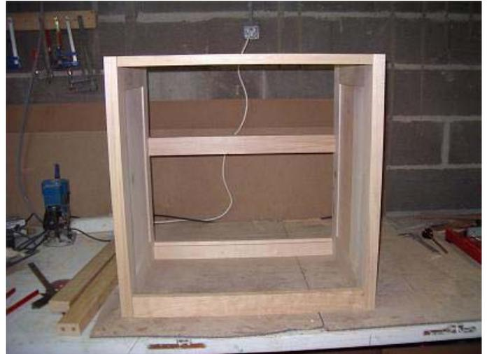
Après exécution des assemblages et des rainures des cadres des cotés, les panneaux latéraux sont mis au format et une plate-bande est usinée. Refaire un ponçage de finition, encoller uniquement les éléments des cadres; assembler et serrer le tout sans oublier de vérifier les équerrages.
