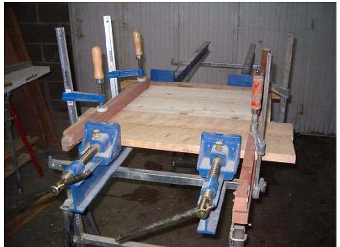
Les panneaux des cotés et des portes sont assemblés. La technique utilisée est affaire de choix. Ici le collage est renforcé des tourillons. Mais ce pourrait être à rainures et languettes (vraies ou fausses), à bouvetage en dents de scie ou simplement à plat-joint. Serrer et laisser sécher la colle.
