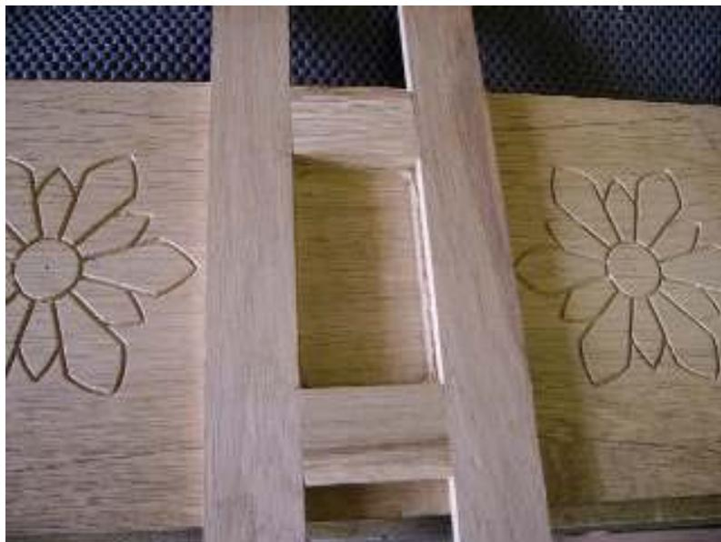
Une fois la seconde rosace terminée, il a fallu défoncer le milieu (pour pouvoir encastrer le carrelage) à l'aide d'un gabarit et de la défonceuse équipée d'une fraise droite avec roulement .
