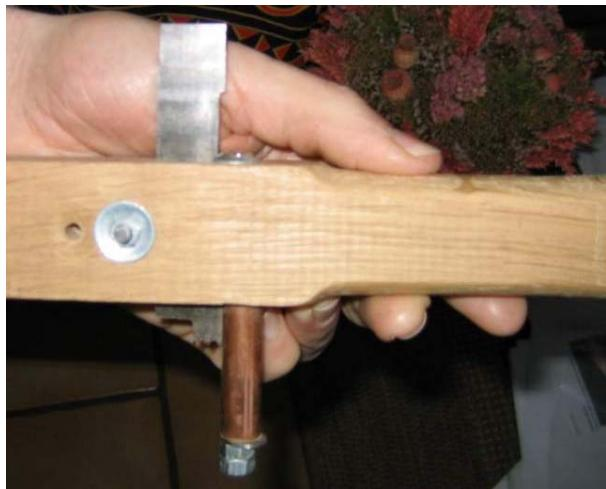
Les moulures sont faites à la main au moyen d'un tarabiscot fait maison. Le profil des fers est taillé à la lime dans un morceau de scie à ruban. Profilez les moulures patiemment sur de longues pièces de bois corroyées et dans la mesure du possible, droites de fil. Fixez-les sur le rebord d'un établi ou d'un quelconque support stable.
