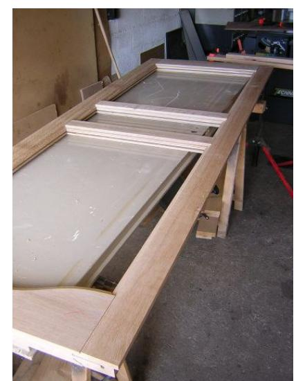
**Préparation au montage :** si vous avez choisi des assemblages chevillés avec ou sans collage, c'est le moment de percer les montants de part en part au niveau des mortaises.
