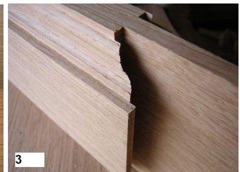
Avec un gabarit, tracez les chapeaux de gendarme des traverses hautes, faites une pré découpe puis calibrez à la toupie en ayant préalablement fixé le gabarit au niveau des tenons (photo 4). L'usinage final pourra se faire au calibreur et lunette. Cette dernière venant en appui sur un gabarit (photo 5).
