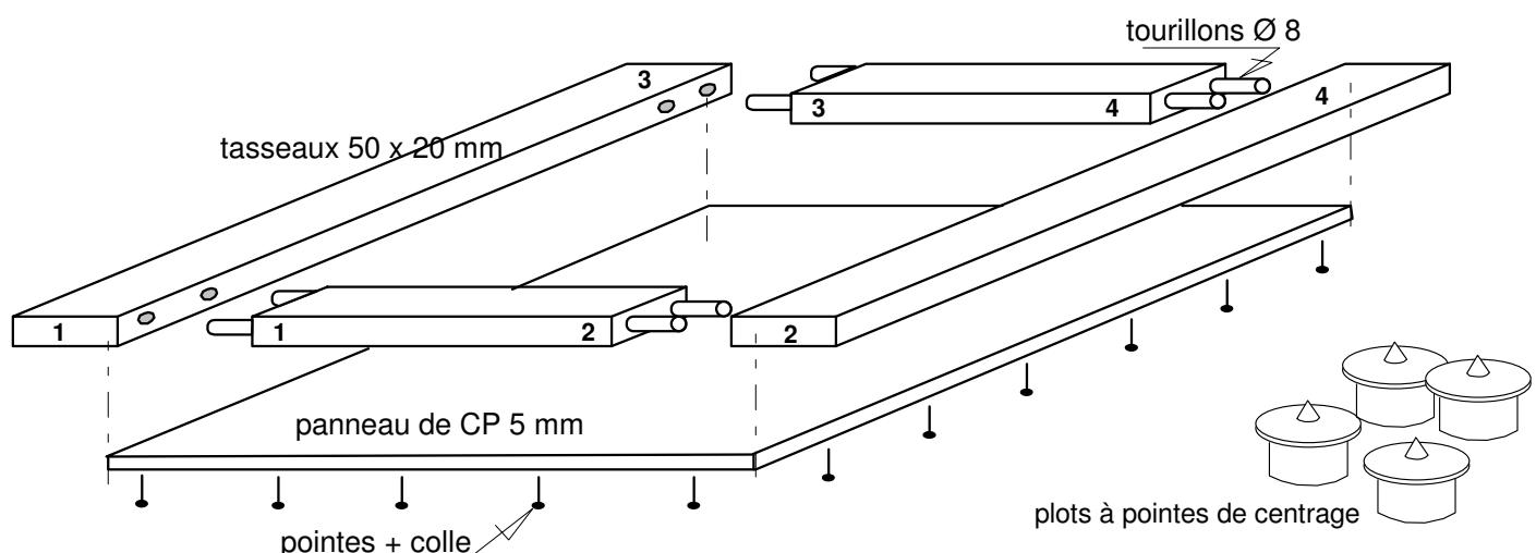
Mettre les tasseaux à longueur avec la scie à dos et la boîte à coupe. Les positionner et les repérer par des chiffres ou des lettres. Dans le bout des traverses, percer les trous des tourillons y placer les plots à centrer. Pointer les plots sur les montants et percer les montants. Faire un premier assemblage pour vérifier l'équerrage et les arasement des pièces de bois.
