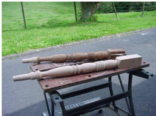
Les deux pieds ont été réalisés dans du chêne. Le neuf semble plus long que l'ancien : mis à part la partie carrée qui doit être recoupée, le reste possède les mêmes dimensions.
