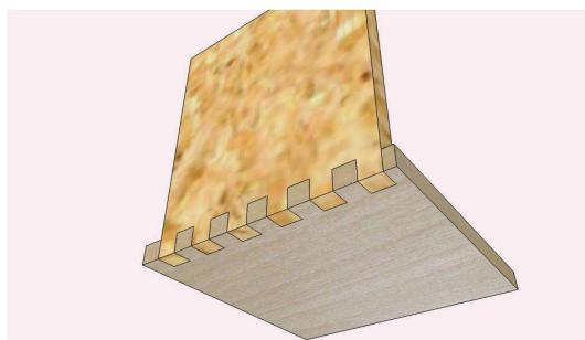
Un coup de scie bien perpendiculairement à l'assemblage.
