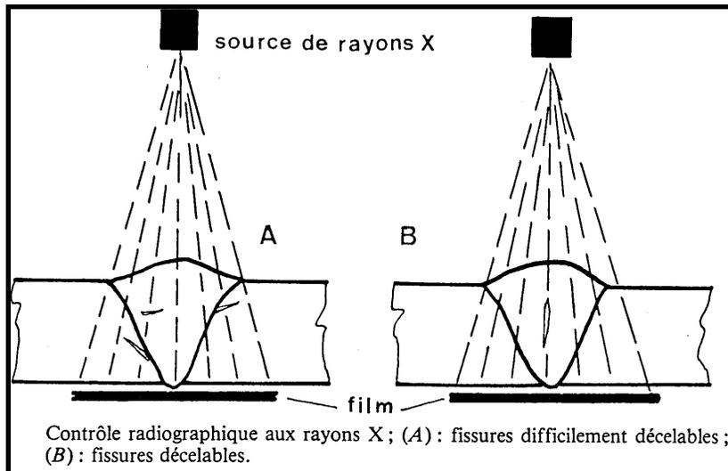
Les défauts apparaîtront sous forme de tâches claires sur fond noir, car les rayons n'auront pas été totalement absorbés par le matériau.
