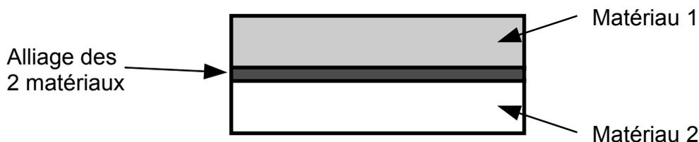
Les pièces doivent être désoxydées et dégraissées; leur état de surface doit être de faible rugosité ( $< 1\mu\text{m}$ ).
