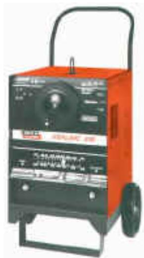
La mise au point des redresseurs a facilité la fabrication des soudeuses mixtes, qui peuvent fournir soit un courant alternatif, soit un courant continu (figure 1.31). On peut alors combiner les avantages de ces deux types d'appareils en faisant appel au courant continu pour exécuter certains travaux, tandis qu'on utilise le courant alternatif pour d'autres.
