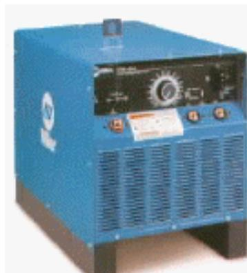
Les redresseurs permettent d'obtenir une polarité normale ou inversée. La soudeuse à courant continu peut être considérée, de manière générale, préférable à celle à courant alternatif en raison de la grande stabilité de l'arc qu'elle produit. De plus, elle permet de varier à loisir l'intensité de soudage.
