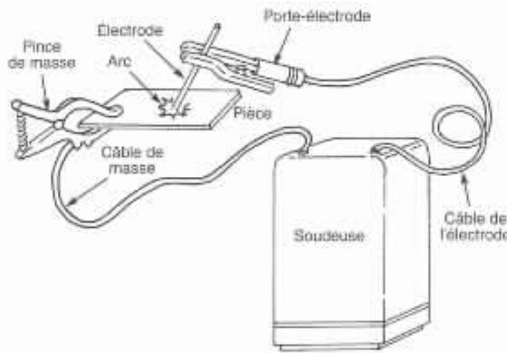
Un circuit électrique de soudage à l'arc comprend plusieurs résistances : long câble de masse, long câble de l'électrode, connexions, électrode, arc, etc.
