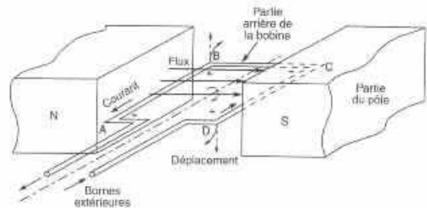
Lorsque le fil monte ou descend dans le champ magnétique, un courant est produit. À cause du mouvement de rotation, lorsque le fil arrive en haut ou en bas de sa course, il se déplace dans le même plan que le champ magnétique et aucun courant n'est produit, puisque le fil ne coupe pas les lignes de force.
