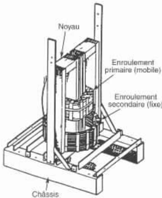
Lorsqu'un courant circule dans l'enroulement primaire, un champ magnétique est produit. Ce champ magnétique, porté de l'autre côté du cadre d'acier, peut être récupéré par un enroulement de fil conducteur placé à cet endroit. On parle alors d'une tension induite, résultant en un courant induit dans l'enroulement secondaire.
