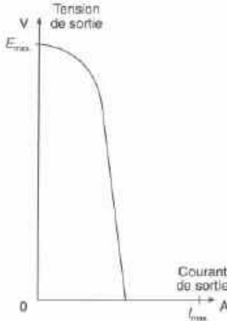
La relation entre la tension et l'intensité du courant à la sortie d'une soudeuse, réglée à une puissance quelconque. On peut remarquer que, pour une grande différence de tension, l'intensité du courant ne varie pas beaucoup. C'est ce que l'on appelle une courbe caractéristique plongeante ou tombante. Les soudeuses présentant une telle courbe sont des soudeuses à courant constant.
