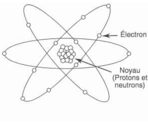
On peut définir le courant électrique comme le déplacement de particules chargées électriquement circulant dans une direction donnée. Par exemple, supposez que l'on observe une tige de cuivre à l'aide d'un microscope tellement puissant qu'il devienne possible de voir les petites particules composant l'ensemble de la tige. On pourrait alors voir quelque chose qui ressemblerait à ce qui apparaît à la figure ci-dessous.
