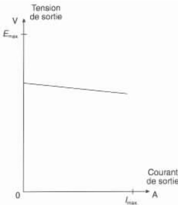
La relation entre la tension et l'intensité du courant à la sortie d'une soudeuse à tension constante ou à potentiel constant. En effet, pour une grande plage d'intensités, la tension de sortie ne varie que très peu. Il s'agit d'une courbe caractéristique plate ou horizontale.
