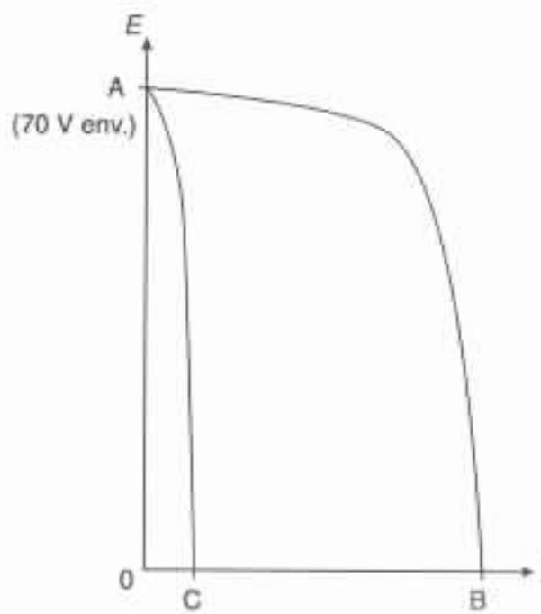
**Le point A représente la tension à vide, c'est-à-dire la tension lue lorsque le circuit de soudage n'est pas encore en fonction, avant d'amorcer un arc (intensité du courant = 0). La tension à vide se situe entre 60 et 80 V environ, pour faciliter l'amorçage de l'arc.**
