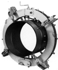
Figure 12 – Clamp avec vérins de reformage « Dearman »
