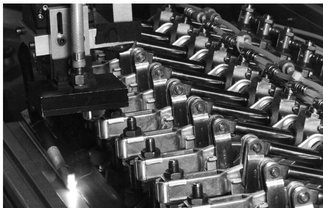
Figure 7 – Outillage de soudage par transparence de tôles de 1 mm par procédé laser
