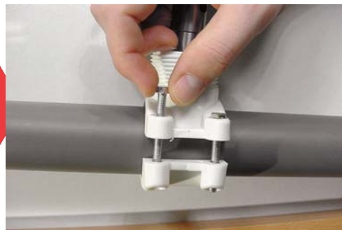
4 - Vissez la bride sur la canalisation.
