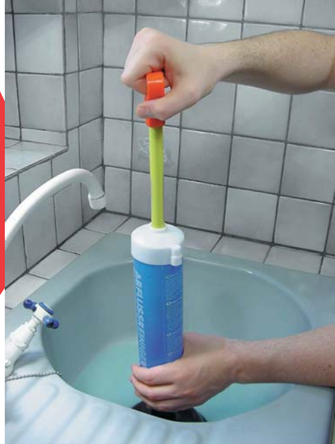
3 - Actionnez le déboucheur jusqu'à ce que l'eau s'écoule, puis faites couler de l'eau chaude.
