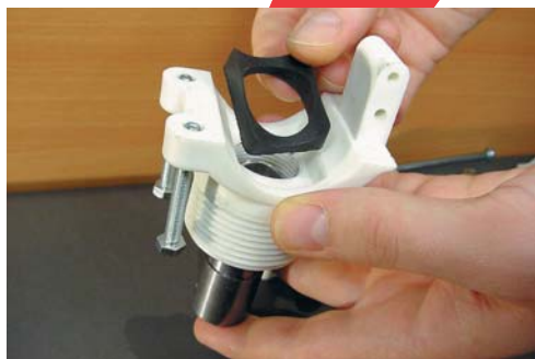
2 - Placez le joint d'étanchéité de l'élément supérieur.
