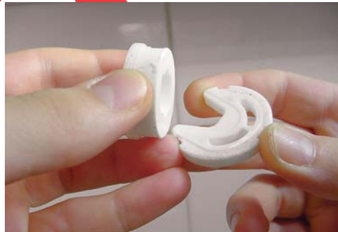
5 - Vérifiez l'état des disques et remplacez-les si nécessaire. Maniez-les avec précaution !
