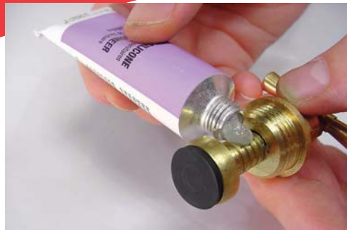
6 - Avant le remontage, enduisez la tige de commande et le clapet de graisse spéciale au silicone.
