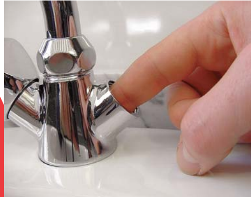
1 - Vérifiez l'état du siège avec le doigt.
