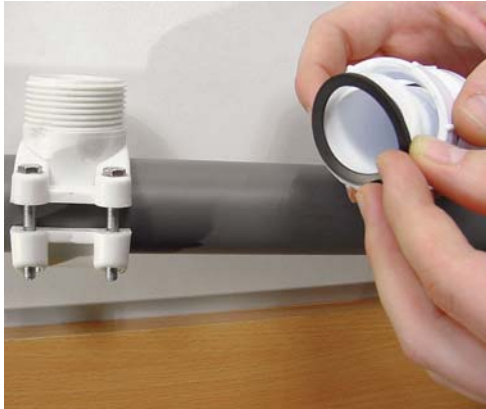
7 - Placez le joint sur le siphon.
