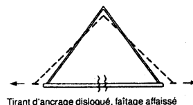
④ Enlever les contre-fiches entraîne un déplacement du toit sous la pression du vent.
