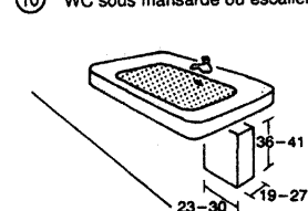
⑭ Chauffe-eau sous lavabo.
