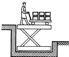
⑦ Passage du niveau quai au niveau cour par plate-forme de levage hydraulique en ciseaux.
