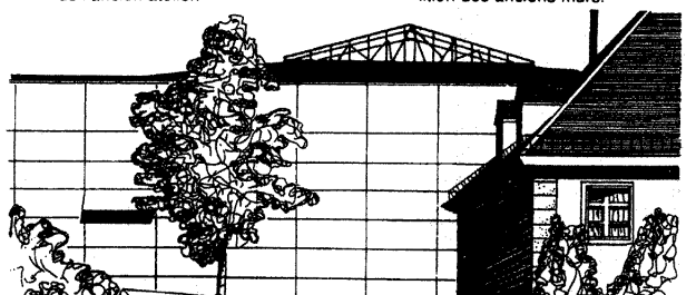
⑥ Montage de la nouvelle construction en acier par dessus le toit existant de l'ancien atelier.
