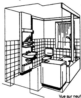
9 Passage de canalisations derrière aménagements en saillie.
