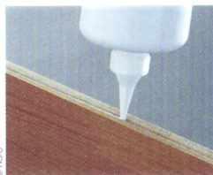
Assemblage par collage en rainure et languette
