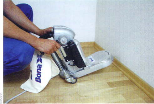
Allumez toujours la bordeuse en l'inclinant pour relever son plateau.
