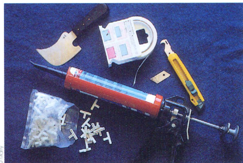
Prévoyez un couteau quart-de-lune, du ruban de masquage, 1 cutter, des T et du mastic spécial.
