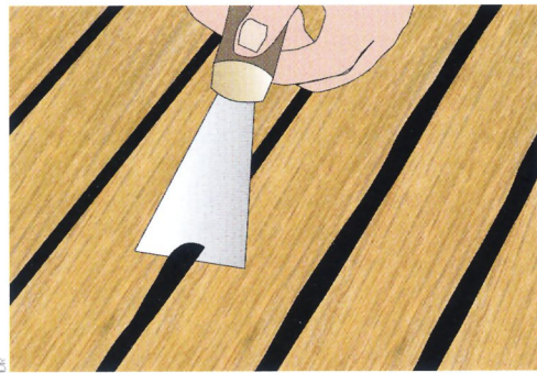
4 - Retirez éventuellement les excédents de mastic au moyen d'une spatule.
