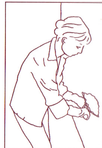
Le platoir en inox sert à distribuer la chaux sur le mur, du bas vers le haut.
