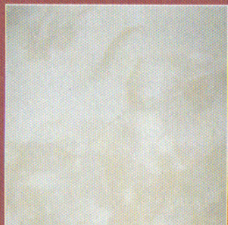
Enduit teinté dans la masse avec de la terre de Sienne naturelle.
