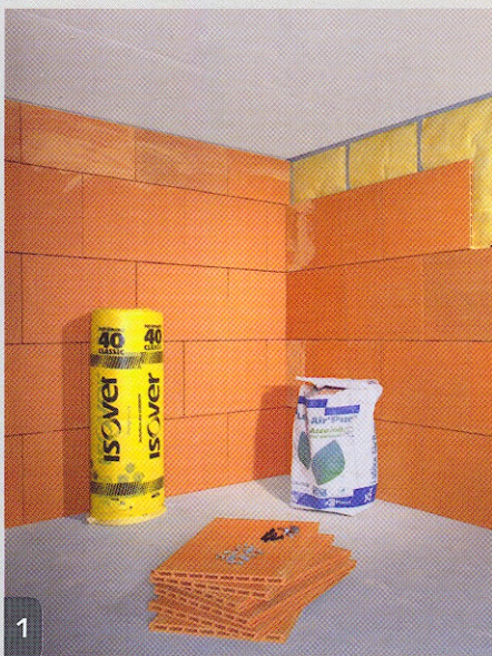
1 Les plaques de terre cuite montées mécaniquement sur une ossature métallique (« système Intuitys » de Imerys Terre Cuite) n'apportent pas d'humidité. Elles s'utilisent en cloison ou en doublage de mur avec un isolant intégré dans l'ossature.
